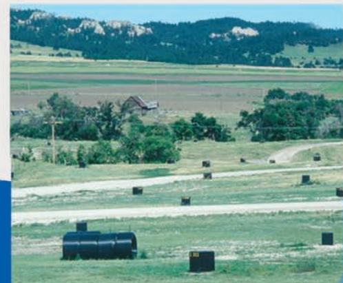
Bild rechts: Oberflächenansicht einer ISR-Mine
